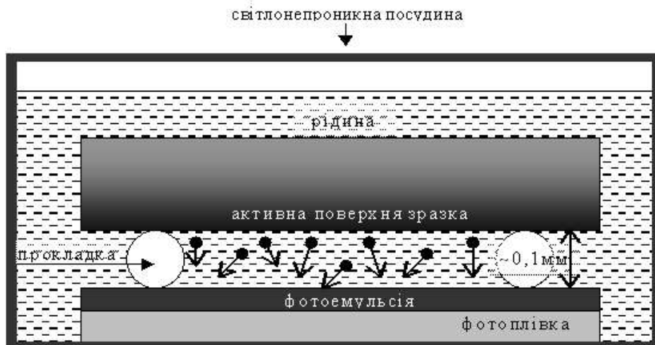
Рис. 1. Загальна схема одержання хемограм. Умовно показано дифузійний рух хемографічно активних продуктів від джерела до фотоемульсії.
