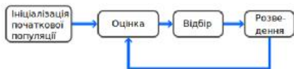
Рис. 2. Загальний цикл роботи генетичного алгоритму
