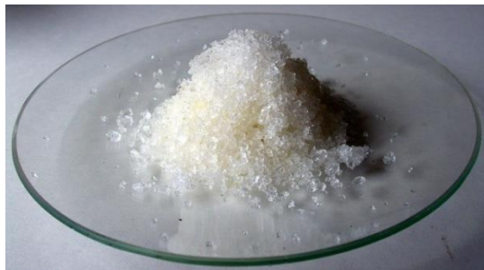
Рис. 2.4. Загальний вигляд кристалів нітрату кадмію
