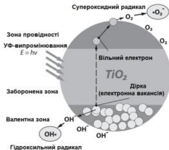
Рисунок 2.4. Схематичне зображення процесу фотокаталізу на поверхні діоксиду титану
