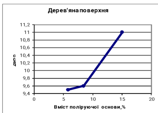
Рис.3,4,5. Графіки залежності часу (сек.) желатинізації поліролей (№№1,2,3 таб.2) на поверхнях різної природи: 1-дервяна,2-металева,3-шкіряна від вмісту поліруючої основи в поліролях .
