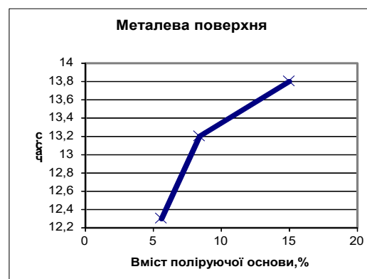
Рис.3,4,5. Графіки залежності часу (сек.) желатинізації поліролей (№№1,2,3 таб.2) на поверхнях різної природи: 1-дервяна,2-металева,3-шкіряна від вмісту поліруючої основи в поліролях .
