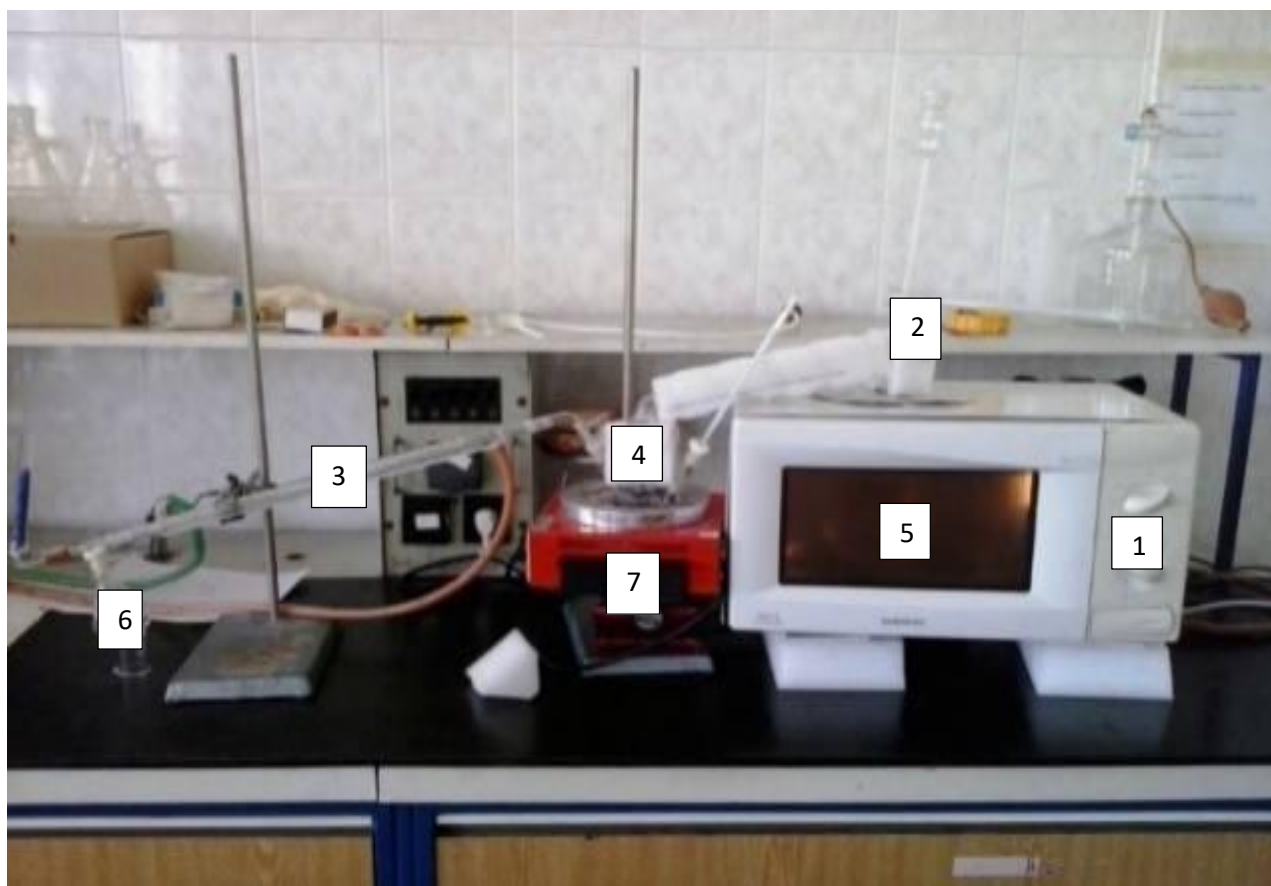
Рис. 6. Лабораторна установка для видалення кавових ароматів із подрібнених кавових зерен водно-спиртовими парами за допомогою мікрохвильової печі Delfa D20MW -1, Зворотного скляного холодильник-дефлегматор -2, прямого водяного холодильника -3, трьохгорлої колби для перегонки з водяним паром-4, парогенератора пари-в печі НВЧ-5, приймальної колби для відгону кавових смаків і ароматів-6, магнітна мішалка з підігрівом-7.
