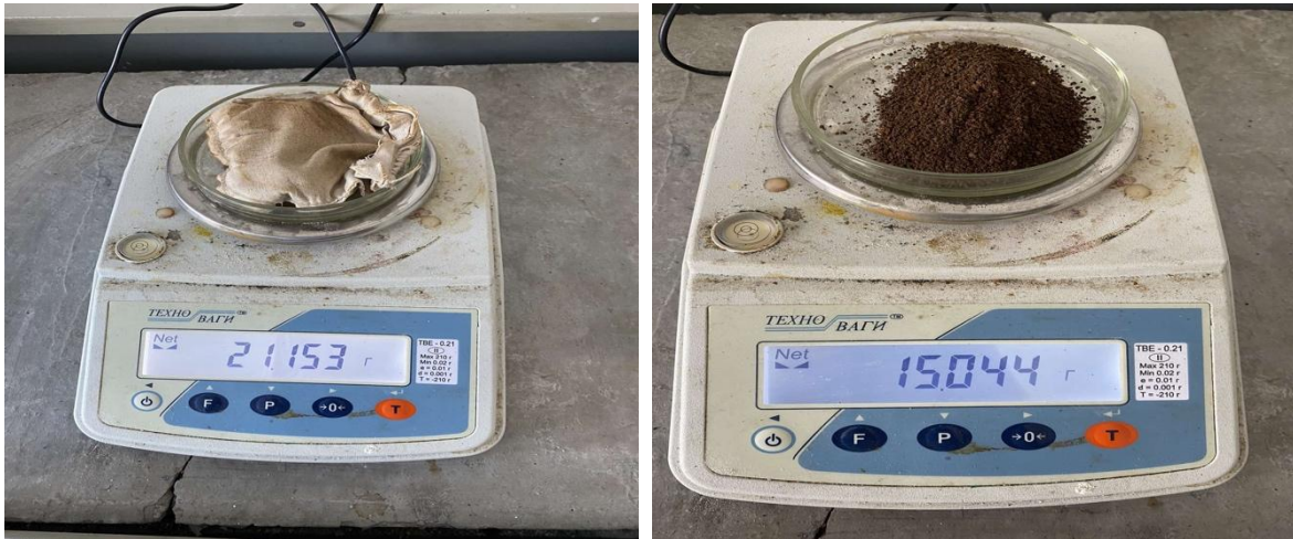
Рис. 16. Зображення зважування порошку кави після витяжки в апараті Сокстлетта на визначення сухого залишку (С,%) у H_2O та винному спирті. Результати після витяжки кави:
