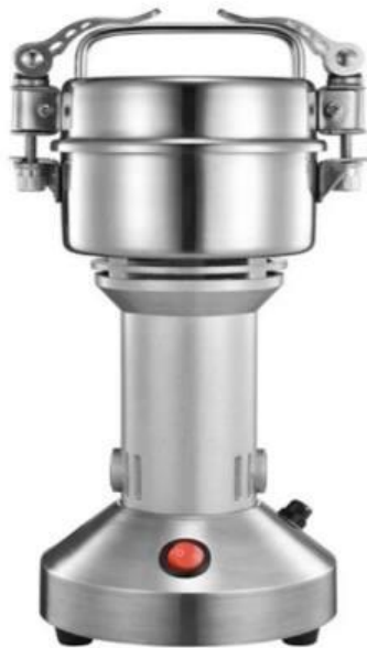
Рис. 5. Лабораторний високошвидкісний млин(подрібнювач НС-150)
