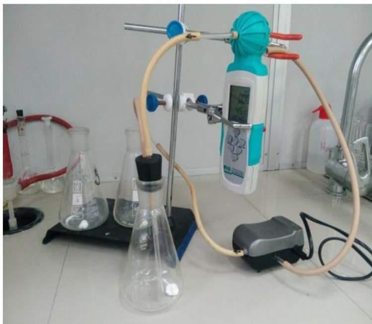
Рис.2.3. Установка для вимірювання емісії вільного газоподібного формальдегіду: штатив, колба місткістю 500 мл, газоаналізатор на формальдегід МІС-98170, повітря дувка акваріумна для подачі повітря із двома трубками (1 – трубка, яка видуває повітря; 2 – трубка що вбирає повітря); зразок КФС або пінопласту в колбі.
