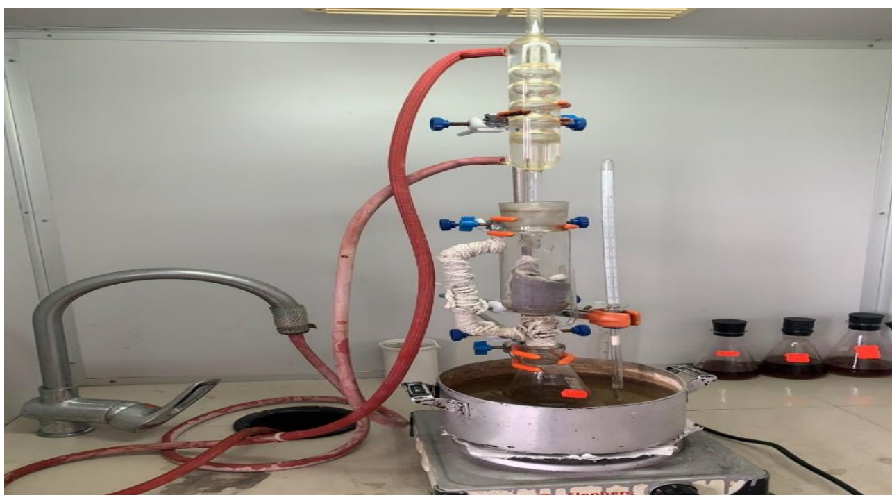
Фото № 2.4. Лабораторна установка для екстракції сквалену з насіння амаранту в органічному розчиннику, апарат Сокстлетта
