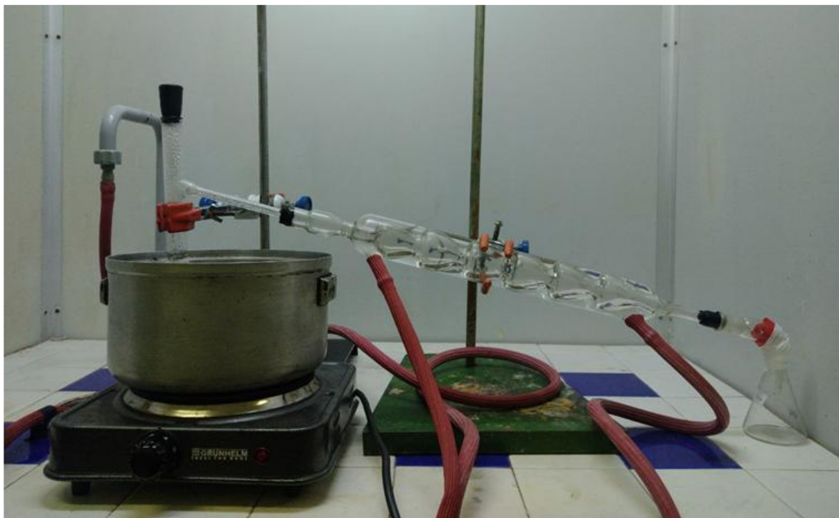
Рис. 2.11. Лабораторна установка для отримання ефірної олії
