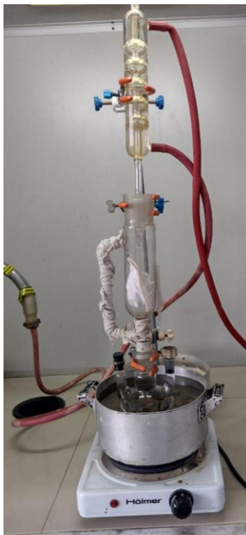
Рис. 2.12. Установка для проведення екстракції в апараті Сокслета
