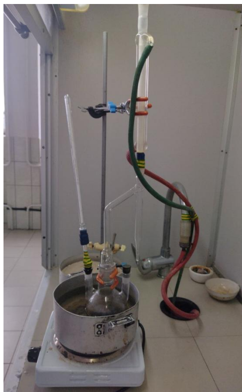
Рис. 2.8. Установка для визначення води дистиляційним методом
