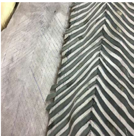
Рис. 3.2.19. Складний метод розшивання чорнобурки шкірою
