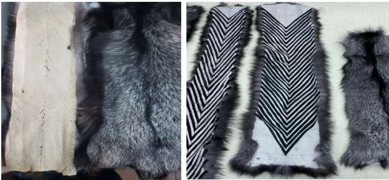
Рис. 3.2.20 Метод розпуску (видовження) та розшивки хутра ч/б за допомогою шкіри або тасьми
