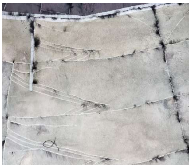
Рис. 3.2.13 (б). Метод осадження норкових шкурок(шаблон стає коротшим, але ширшим) Рис.3.2.13(в)Метод перфорації чорнобурки
