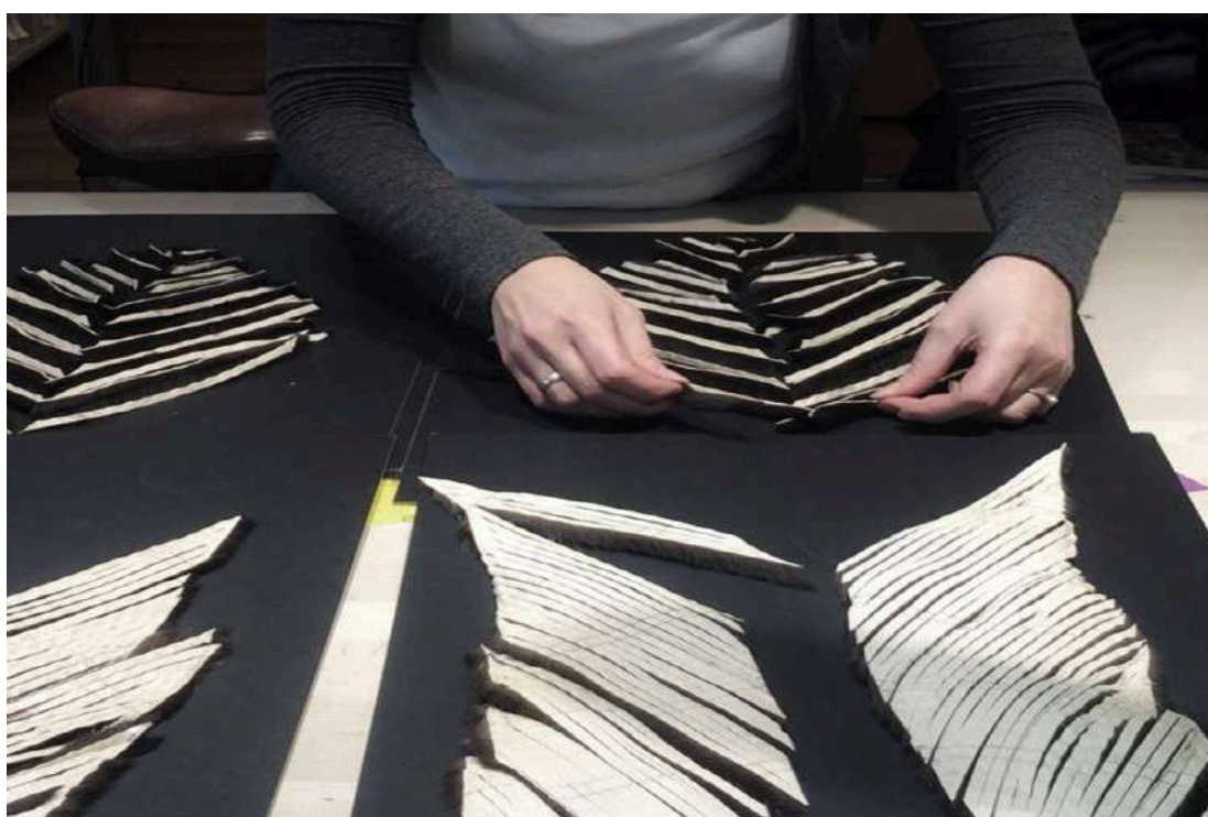
Рис. 3.2.10. Метод розпуску, розшивки. Шкурка розрізається на частини – смуги, клини, зубці, модулі, сегменти – після чого вони з'єднуються у новій послідовності
