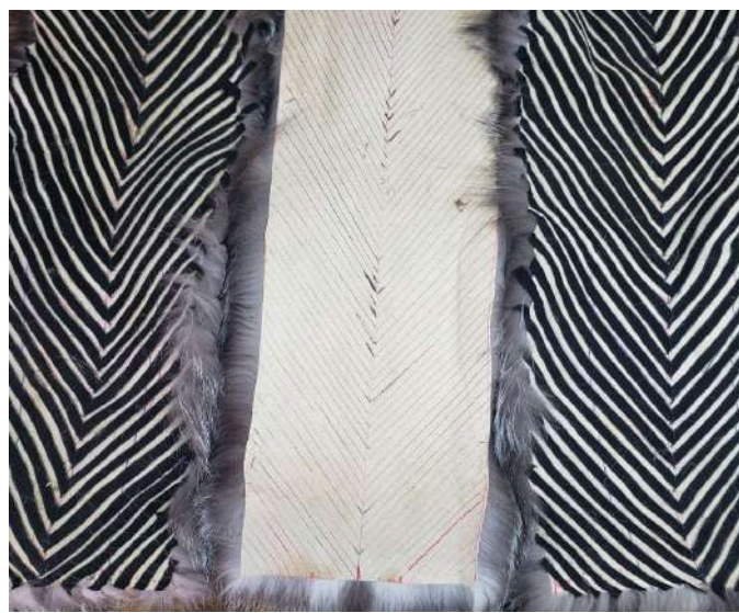
Рис. 3.2.19. Складний метод розшивання чорнобурки шкірою
